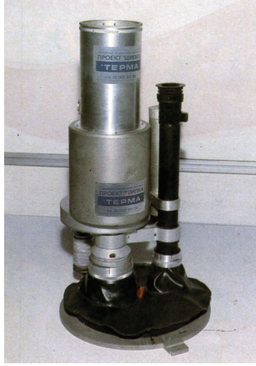
Şekil -1 İmpuls prensibiyle çalışan “Terma” adlı foto metrik cihaz.
