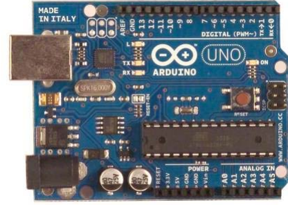
Şekil 3 Arduinio UNO Elektronik Kartı
