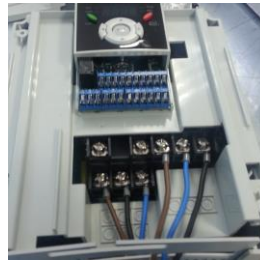
Şekil 6. İnvörtör ve bağlantı şekli
